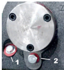
Рисунок 3 – Маслозаливная и сливная пробки
