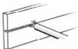
Рисунок 13. Горизонтальное положение при сварке
