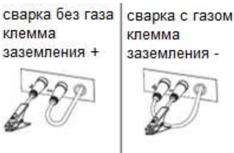
Рисунок 15. Полярность при полуавтоматической сварке
