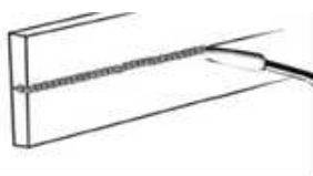
Рисунок 21. Сварка в горизонтальном положении
