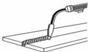
Рисунок 20. Сварка в нижнем положении
