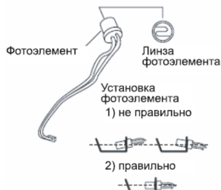
Рис. 20 Установка фотоэлемента
