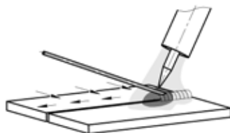
Рис. 8.6. Пример манипуляции присадочной проволокой при TIG сварке.
