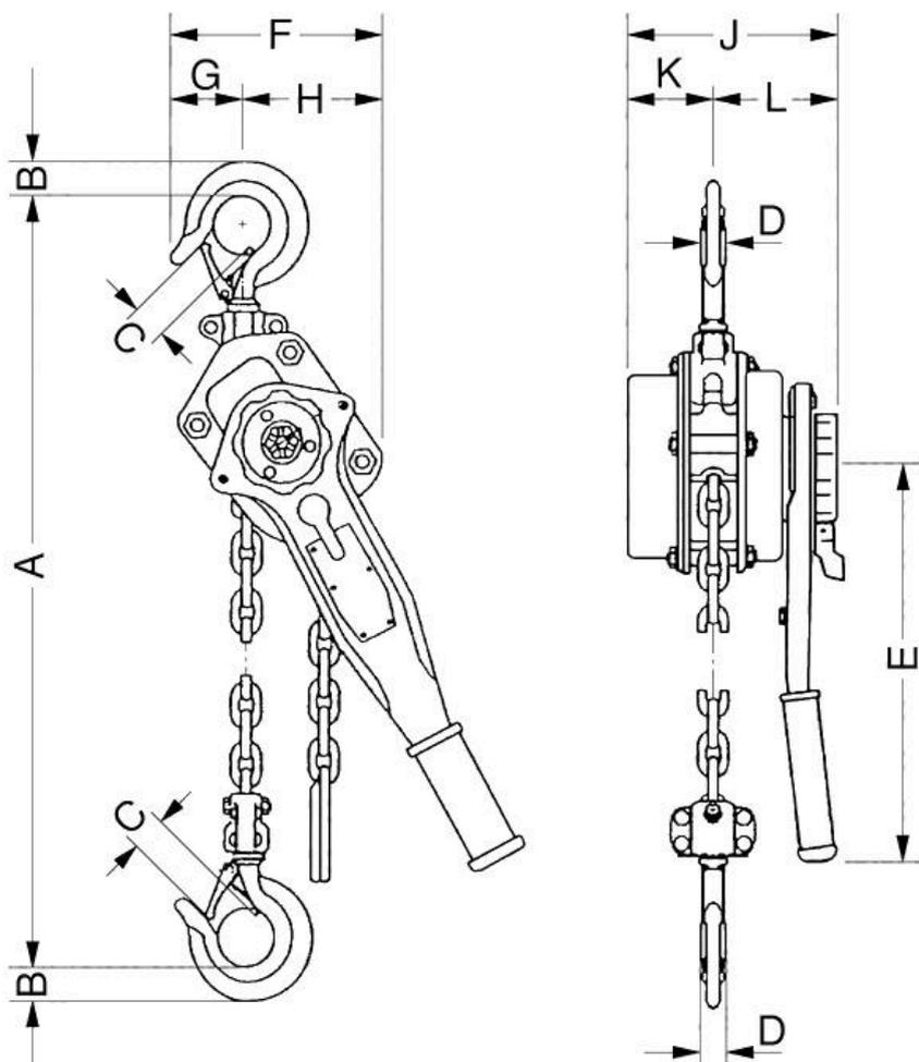
Обозначенные на схеме размеры для тали ТРШСР-6,0 в мм: **A=690**; **B=45**; **C=44**; **D=33**; **E=380**; **F=220**; **G=100**; **H=120**; **J=210**; **K=90**; **L=120**. Таль ТРШСР-6,0 имеет 2 ветви грузовой цепи, но на схеме условно показана одна ветвь (схема общая для всех талей ТРШСР).
